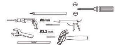
Alati i pribor: (libela; metar; ručna električna bušilica; set burgija za beton; odvrtaci - ravni i zvezdasti; viljuškasti ključevi; čekić; olovka).
