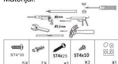
Alati i pribor: (libela; metar; ručna električna bušilica; set burgija za beton; odvrtači - ravni i zvezdasti; viljuškasti ključevi; čekić; olovka).
