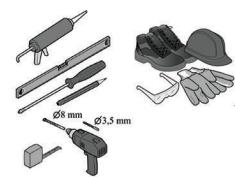
Alati i pribor: (libela; metar; ručna električna bušilica; set burgija za beton; odvrtići - ravni i zvezdasti; viljuškasti ključevi; čekić; olovka).
