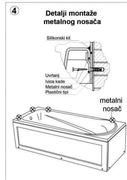
Montirati odvodni sifon i povezati ga sa kanalizacionim odvodom na zidu ili podu. Kada se zatim postavlja (kači) svojim ivicama na nosače, kako je prikazano na slici, tako da se ona ne može više horizontalno pomerati.
